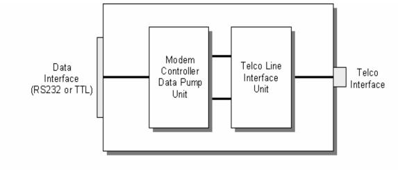
Figure 1 TYPICAL MODEM CONFIGURATION
